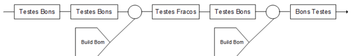
Figura 2.5: Identificação para bases estáveis. Adaptado de Berczuk e Appleton (2002).
